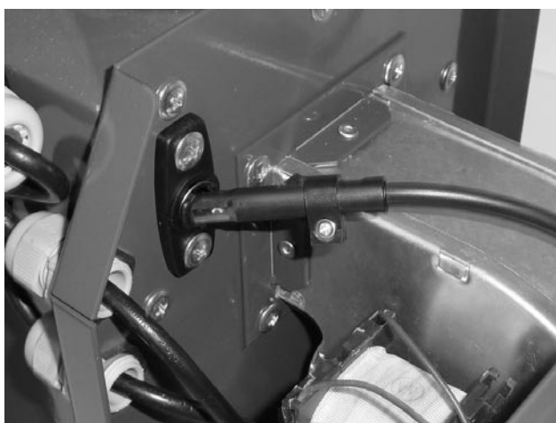
Fig. 6 – fotocelula – atenție la orientarea corectă - recomandăm cel puțin o curățare o dată pe an
