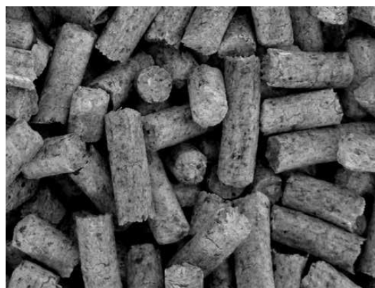
Fig. 18 – pelete de lemn de calitate inferioară – de culoare închisă, cu coajă (cu puncte negre)
