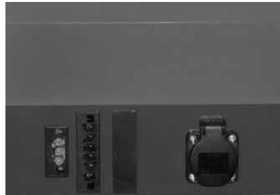
Fig. 12– arzător cu 2 conectori cu 6 pini, stânga- alimentare, dreapta- senzori, conector cu 3 pini pentru senzorul de turație al ventilatorului cazanului și priză pentru transportorul de peleți.
