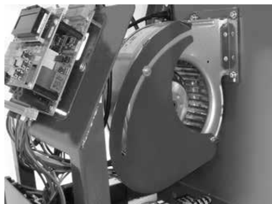
Fig. 7 – ventilatorul arzătorului cu clapetă de aer
