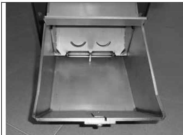
Fig. 3 – camera de ardere descoperită cu duzele sistemului automat de curățare și orificiile în spatele cărora sunt plasate spiralele de aprindere
