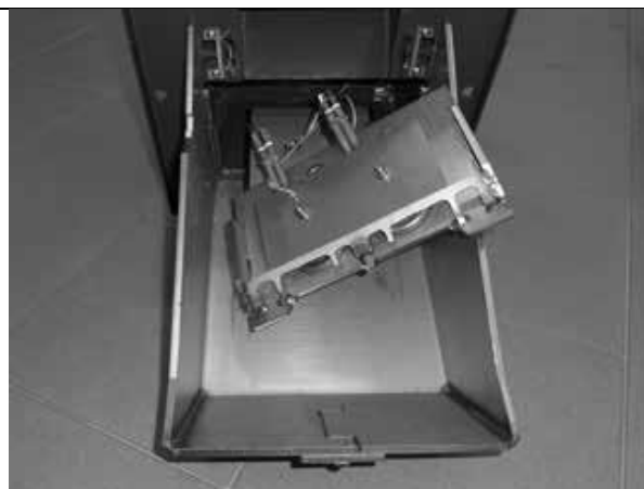
Fig. 4 – placa demontată cu spirale de aprindere
