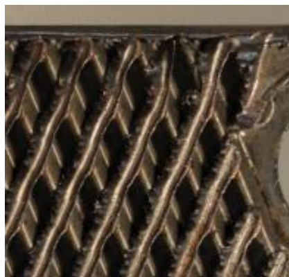
Fig A4. Imagine după, circuit primar de apă curățat
