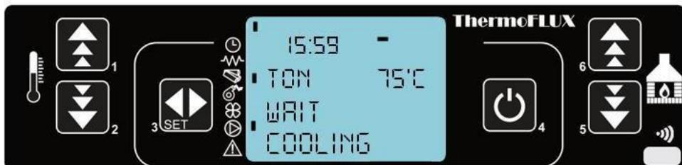
Cand temperatura in termosemineu scade cu 2 °C sub cea setata regulatorul va initializa din nou sevanta de aprindere.
