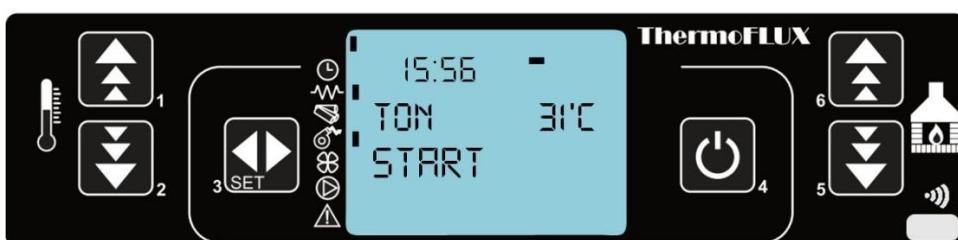
Se va afisa START, iar in partea stanga pe display vor aparea aprinzatorul si ventilatorul de aspiratie activate. Marcajul tON indica faptul ca termostatul este conectat sau inchis la conectare pentru termostatul de camera (implic it).
