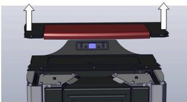
Sub capac se afla 2 placi ( Interio 14 are una singura) sub care există un loc în care se tine parghia pentru curatare.
